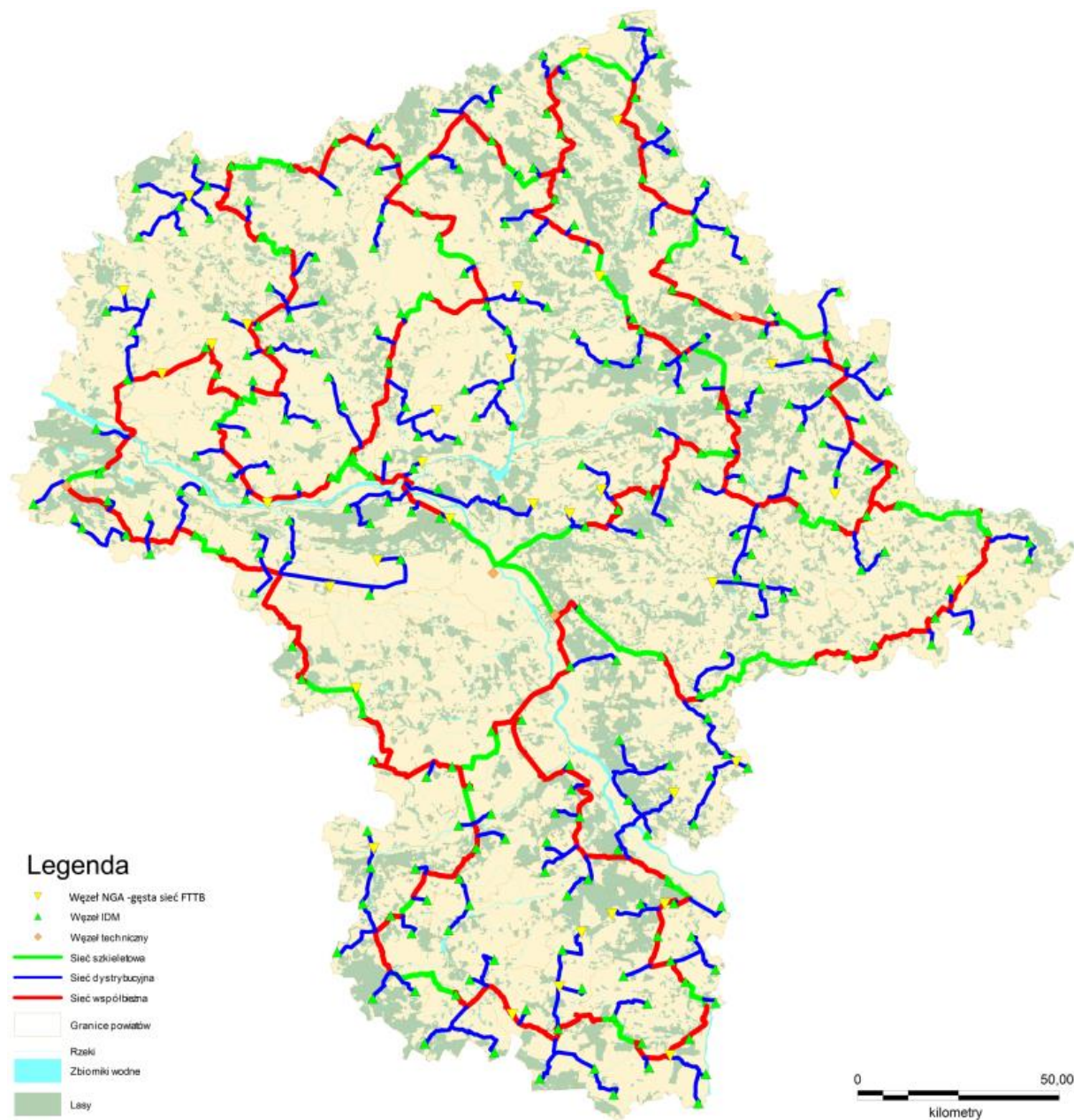
Rysunek 39. Przebieg światłowodowej sieci szkieletowej w ramach projektu „Internet dla Mazowsza”
